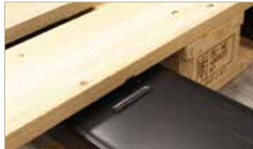
Gelaserte Markierung an Gabeln für optimale Position des Hubwagens bei seitlichem Einfahren in Palette
